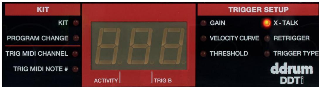
O CROSSTALK ocorre quando os *triggers* nas proximidades são falsamente acionados. Por exemplo, ao usares *triggers* de bateria acústica montados num kit de bateria, bateres num certo *pad* pode fazer com que a bateria vibre e outros *triggers* também. Não há uma maneira definitiva de lidar com o CROSSTALK. Definir uma combinação de GAIN e THRESHOLD para cada *trigger* pode ajudar a aliviar o CROSSTALK. Tu também podes usar a função X-TALK.
