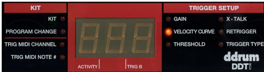
A VELOCITY CURVE descreve como a velocidade de um *trigger* varia com a força aplicada. Este é um recurso útil ao tentares personalizar como um *trigger* responde ao teu estilo de tocar.
