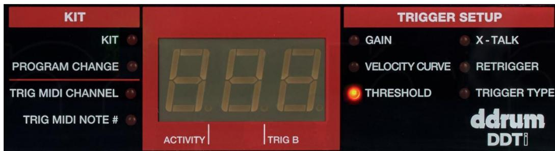
O disparo falso ocorre quando um *trigger* é acionado acidentalmente, geralmente devido a vibrações do teu *set*. A configuração de THRESHOLD pode ajudar a evitar disparos falsos. Valores altos de THRESHOLD exigirão que batas mais no *pad* para registar uma nota. O THRESHOLD deve ser definido com base no teu estilo de tocar, então tenta diferentes configurações de THRESHOLD até encontrares um que funcione melhor para ti.
